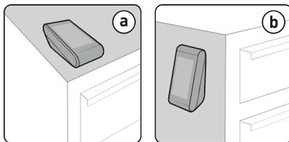
凭借设备下侧的磁面，可将设备固定在合适的金属平面上 (b)，例如桌腿或滑车上。
