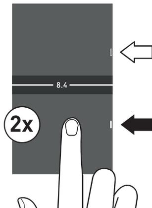
双击横条上方或下方区域，可以在两个输出端之间切换。亮起的符号表明激活的输出端。上次为输出端设定的电压值将再次置位。
