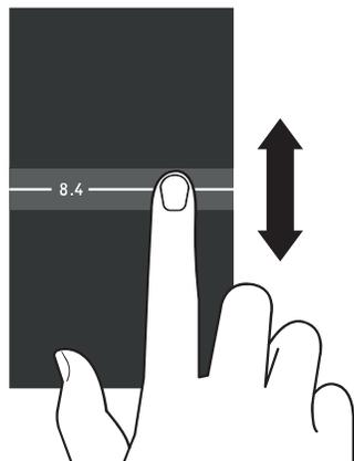
横条中的数值对应了输出电压，单位为伏特。这可以在  $4.7\text{ V} - 12.5\text{ V}$  之间以  $0.1\text{ V}$  的步进变更。将手指放在横条区域并同时移动，可以设置所需的数值。
