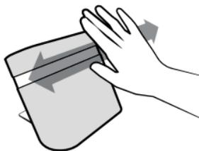
A exibição do gráfico de barras segue o movimento da mão. A frequência de perfuração aumenta conforme você move sua mão para a direita. Se o equipamento for girado em 90°, mova sua mão de baixo para cima para aumentar a frequência de perfuração.
